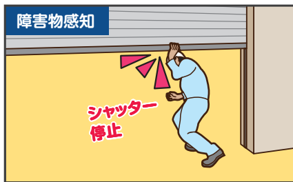
シャッター降下中に、座板部が人などの障害物と接触すると停止します。
