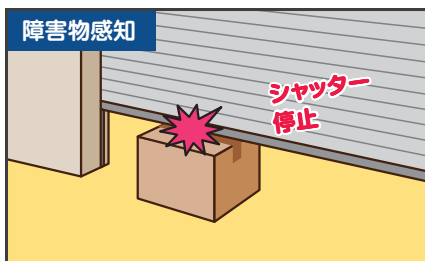
障害物が当たるとシャッターは停止・反転上昇します。
