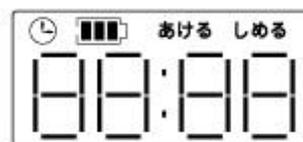
電池の使用期間に応じて、電池交換時期になると液晶画面の「電池交換時期表示」（電池マーク）が点滅します。
