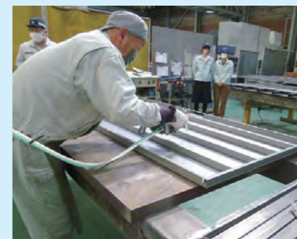
アプリケーションを使用した接着剤塗布の様子
