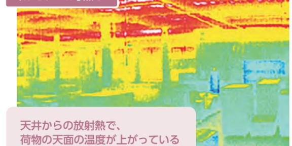
天井からの放射熱で、荷物の天面の温度が上がっている
