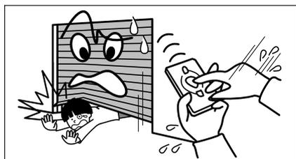
シャッターを閉めているときに開けたい場合は、「STOP」スイッチを押した後、「OPEN」スイッチを2回押ししてください。「STOP」スイッチを押さないと、シャッターは閉まり続けます。
