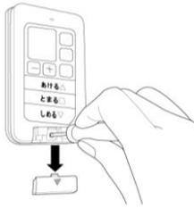
ワイヤレススイッチの取付ねじカバーを外して、プラスドライバーでねじを取り外します。
