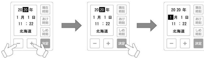
「+」スイッチまたは「-」スイッチを押し、西暦を選択します。「決定スイッチ」を押すと確定され、次の項目（月）が白抜き表示になります。
