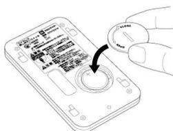
電池蓋をCLOSEの方向（時計回り）に回し、電池蓋を取り付けます。
