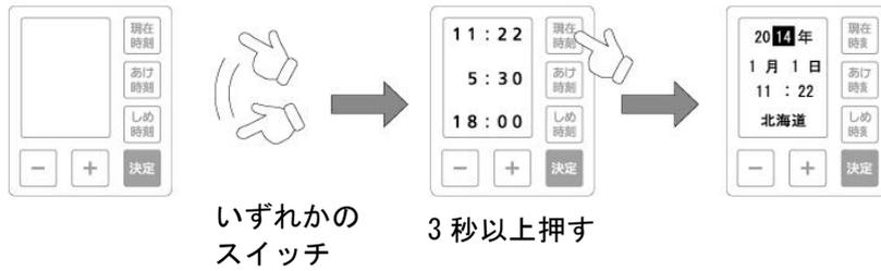
いずれかのスイッチを押して液晶を表示させてから、「現在時刻スイッチ」を3秒以上押しすと、設定モードになります。設定モードになると、西暦が白抜き表示になります。
