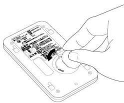
裏面の電池蓋をコイン等で OPEN の方向（反時計回り）に回し、電池蓋を外します。
