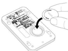
電池蓋を CLOSE の方向（時計回り）に回し、電池蓋を取り付けます。
