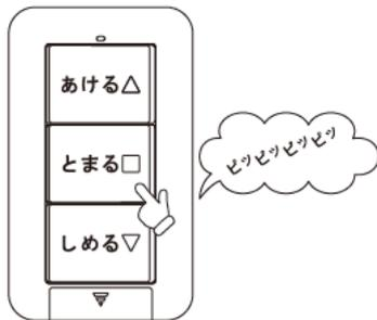
電池が消耗すると、シャッター操作スイッチを押している間、ブザー音が鳴り続けます。
