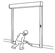
ある程度の高さまでシートを外すと、容易にくぐり抜けて、反 (3)対側に移動することができます。
