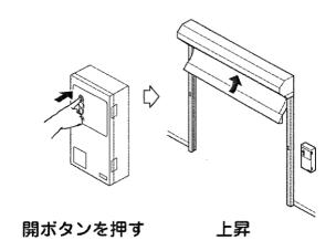
電動にてシートを上限まで上昇させても、元の状態に復帰しない場合は、繰り返しの操作は行なわず、 直ちに文化シヤッターサービスへご連絡いただき、対処を依頼してください。 シートが元にもどらない状態で開閉することでシャッターが故障するおそれがあります。
