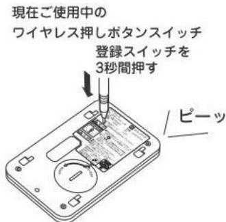
現在ご使用中のワイヤレス押しボタンスイッチの登録スイッチを3秒間押すと、ブザーが1秒間鳴り、送信ランプが点滅し始めます。
