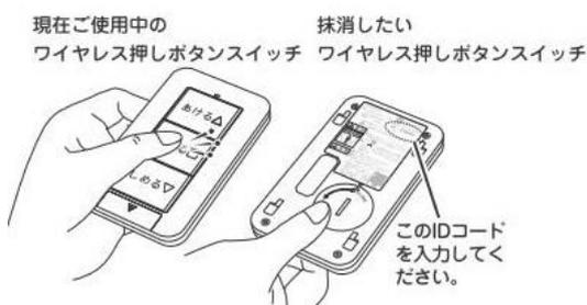
抹消したいワイヤレス押しボタンスイッチの裏面に記載してある ID コードを、現在ご使用のワイヤレス押しボタンスイッチを使って入力します。紛失したワイヤレス押しボタンの ID コードは、「ワイヤレス押しボタンスイッチ (ID コード) の管理表」に貼り付けた ID コードシールを見て、入力してください。
