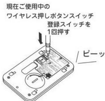
現在ご使用中のワイヤレス押しボタンスイッチの登録スイッチを1回押します。ブザーが1秒間鳴り、送信ランプが消灯して抹消が完了します。抹消したワイヤレス押しボタンスイッチがお手元にある場合は、抹消したワイヤレス押しボタンスイッチでシャッターの開閉をして動かないことを確認してください。シャッターが動く場合は、再度抹消をやり直してください。
