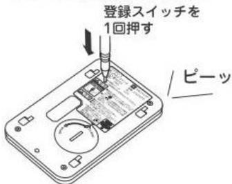
現在ご使用中のワイヤレス押しボタンスイッチの登録スイッチを1回押します。ブザーが1秒間鳴り、送信ランプが消灯して登録が完了します。登録が完了したら、新しいワイヤレス押しボタンスイッチでシャッターの開閉をして動くことを確認してください。シャッターが動かない場合は、再度登録をやり直してください。
