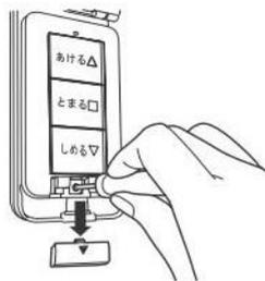
ワイヤレス押しボタンスイッチの取付ねじカバーを外して、プラスドライバーでねじを取り外します。
