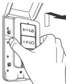
ワイヤレス押しボタンスイッチを上をスライドして、スイッチボックスから取り外します。
