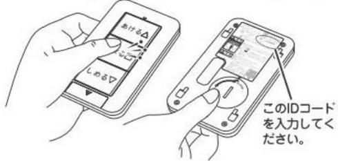
新しいワイヤレス押しボタンスイッチの裏面に記載してある ID コードを、現在ご使用中のワイヤレス押しボタンスイッチを使って入力します。
