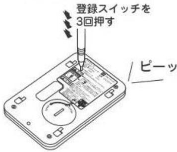
現在ご使用中のワイヤレス押しボタンスイッチの登録スイッチを3回押すと、ブザーが1秒間鳴り、送信ランプが点滅し始めます。
