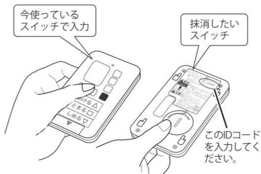
抹消したいワイヤレスタイマースイッチの裏面に記載してある ID コードを、現在ご使用のワイヤレスタイマースイッチを使って入力します。紛失したワイヤレスタイマースイッチの ID コードは、「ワイヤレスタイマースイッチ (ID コード) の管理表」に貼り付けた ID コードシールを見て、入力してください。
