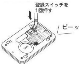
現在ご使用中のワイヤレスタイマースイッチの登録スイッチを1回押します。ブザーが1秒間鳴り、送信ランプが消灯して抹消が完了します。抹消したワイヤレスタイマースイッチがお手元にある場合は、抹消したワイヤレスタイマースイッチでシャッターの開閉をして動かないことを確認してください。シャッターが動く場合は、再度抹消をやり直してください。
