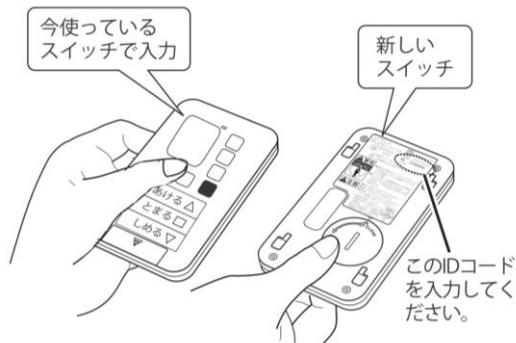
新しいワイヤレスタイマースイッチの裏面に記載してある ID コードを、現在ご使用中のワイヤレス押しボタンスイッチを使って入力します。
