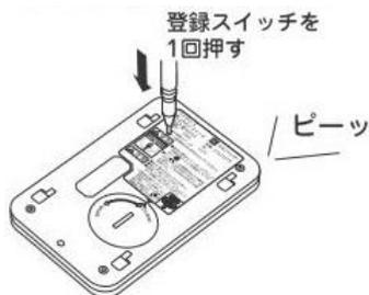
現在ご使用中のワイヤレスタイマースイッチの登録スイッチを1回押します。ブザーが1秒間鳴り、送信ランプが消灯して登録が完了します。登録が完了したら、新しいワイヤレスタイマースイッチでシャッターの開閉をして動くことを確認してください。シャッターが動かない場合は、再度登録をやり直してください。
