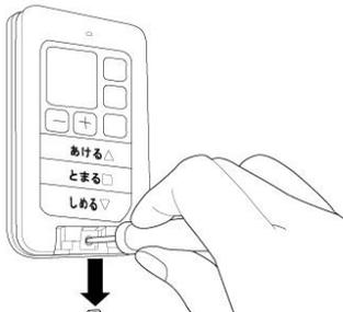
ワイヤレスタイマースイッチの取付ねじカバーを外して、プラスドライバーでねじを取り外します。
